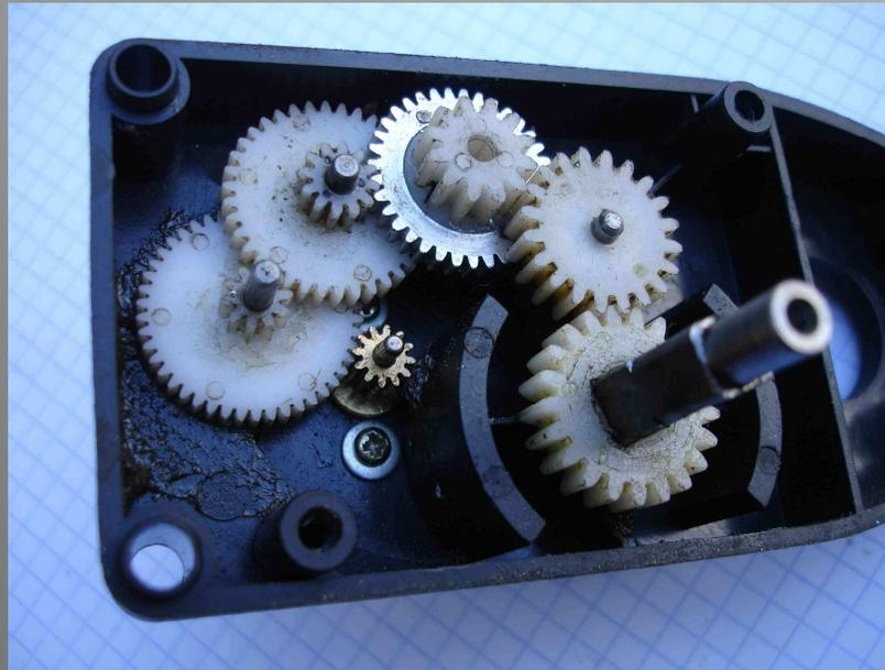
**Avant d'effectuer les essais de fonctionnement, un nettoyage méticuleux et soigné de l'ensemble de la pignonnerie sera réalisé.**
