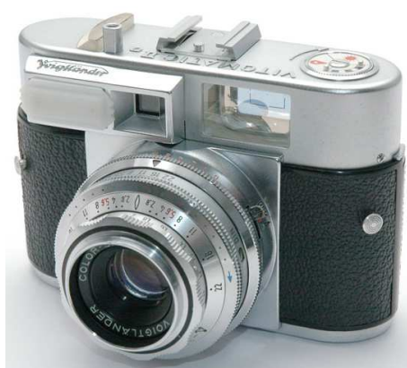
Vitomatic IIa (1961). Obturateur Prontor SLK 1/500 ème . Objectif Color-Skopar f:2,8/50 mm. Posemètre sélénium couplé. Télémètre couplé.
