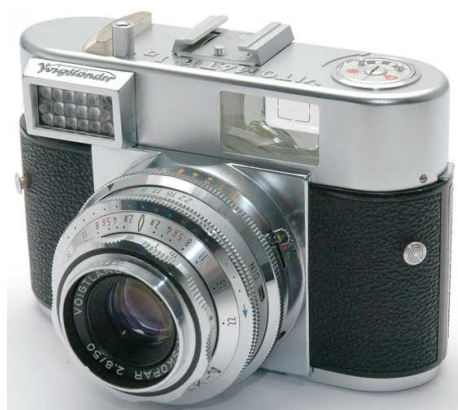
Vitomatic Ia (1961). Obturateur Prontor SLK 1/300 ème . Objectif Color-Skopar f:2,8/50 mm. Posemètre sélénium couplé.
