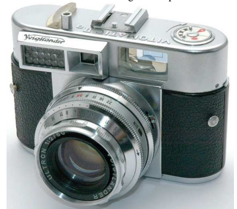
Vitomatic IIa (1961). Obturateur Prontor SLK 1/500 ème . Objectif Ultron f:2/50 mm. Posemètre sélénium couplé. Télémètre couplé.
