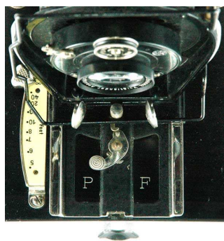
Avus : partie avant de l'abattant montrant les lettres P pour plaque et F pour film : la manette centrale déplace légèrement le bloc objectif-obturateur pour compenser la différence de tirage selon la surface sensible utilisée.
