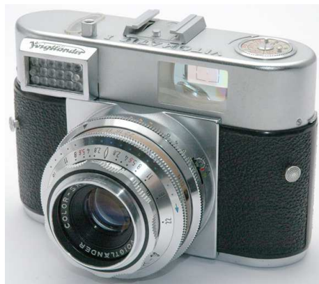
Vitomatic I (1957). Obturateur Prontor SLK 1/300 ème . Objectif Color-Skopar f:2,8/50 mm. Posemètre sélénium couplé.
